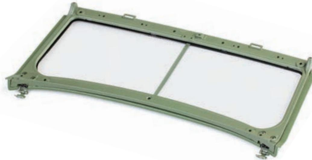
**Шаг 2.** Соедините внутреннюю и внешнюю части рамки ветрового окна. Для этого совместите крепежные отверстия деталей и закрепите их по периметру при помощи шести винтов 1,7×4 (СМ) с внутренней стороны рамки. Четыре винта должны располагаться над ветровым окном, два — в нижних левом и правом углах соответственно.
